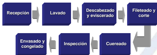
Gráfica 19 Proceso de industrialización del pescado congelado Fuente: CEC-ITAM, 2005.
