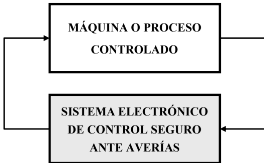
Figura A5.10 Diagrama de bloques de una máquina o proceso controlado por un sistema electrónico seguro ante averías.
