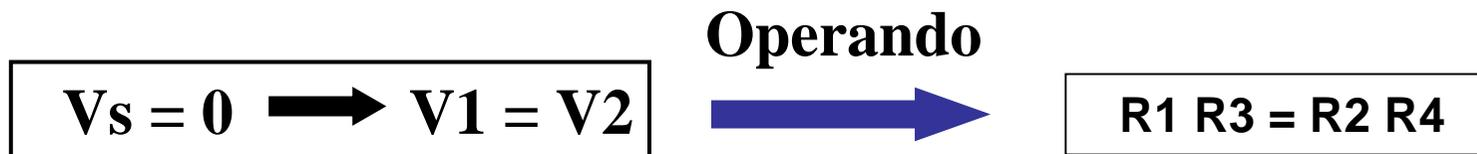
En puentes resistivos  $V_e$  puede ser continua o alterna
