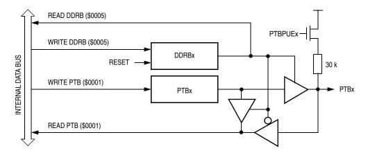
Figure 12-7. Port B I/O Circuit
